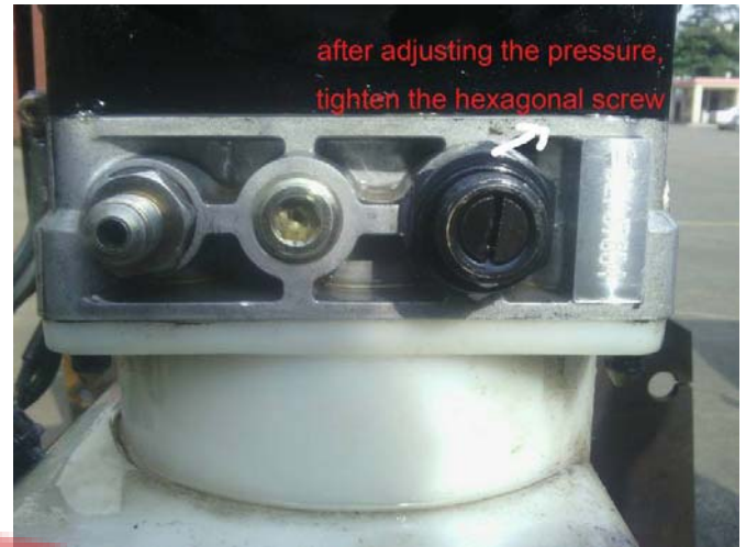
4) После регулировки давления затяните черную контргайку.
