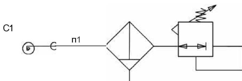
Рис.112 Пневматическая схема станка HW9820
