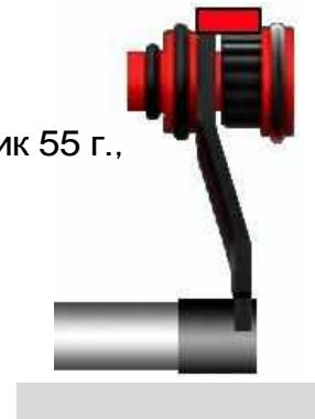
Рис.53 Концевой зажим измерителя
