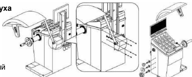
Рис.9 Установка защитного кожуха и штифтов для конусов
