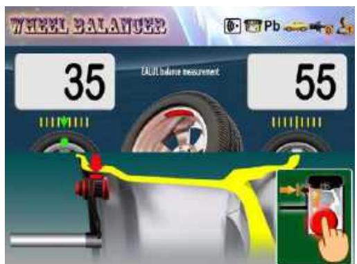
Рис.55 Операция приклеивания грузика на внутренней стороне в режиме EALU
