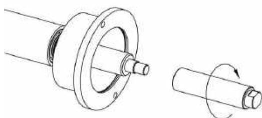
Рис.7 Резьбовой вал HW9810 в сборе
