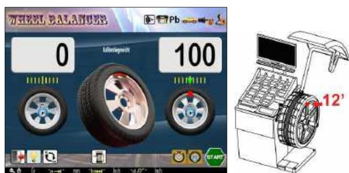
Рис.94 Программа калибровки грузиком 2
