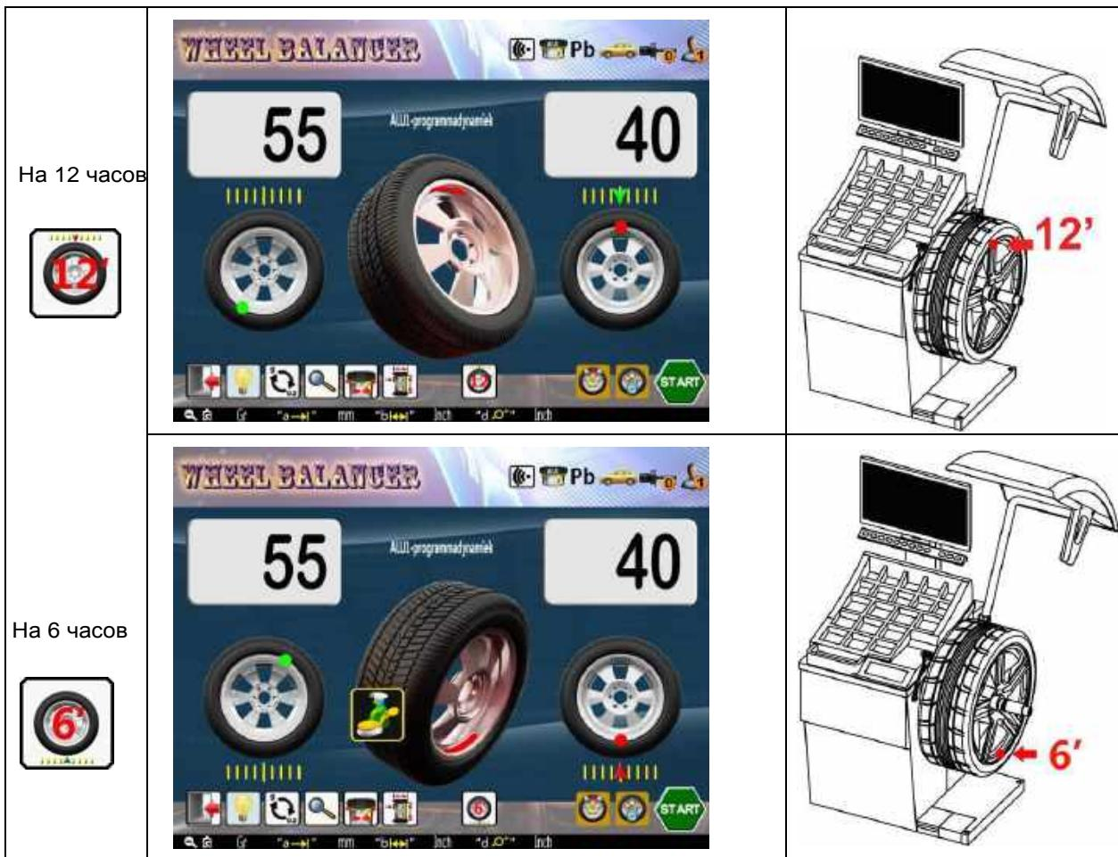
Рис. 49 Балансировка по внутренней плоскости в программе ALU1
