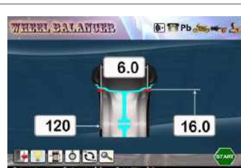
Рис.26 ввод или изменение параметров в режиме мото
