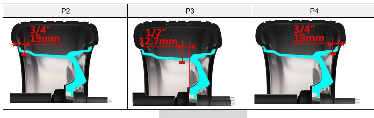
Рис. 30. Положения для клейких грузов
