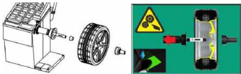
Установка колеса способом «конус–изнутри» Анимация при установке
