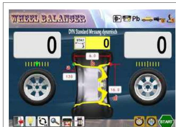
Рис. 31 Стандартная динамическая балансировка
