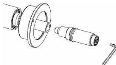
Рис.8 Автоматический вал HW9820
