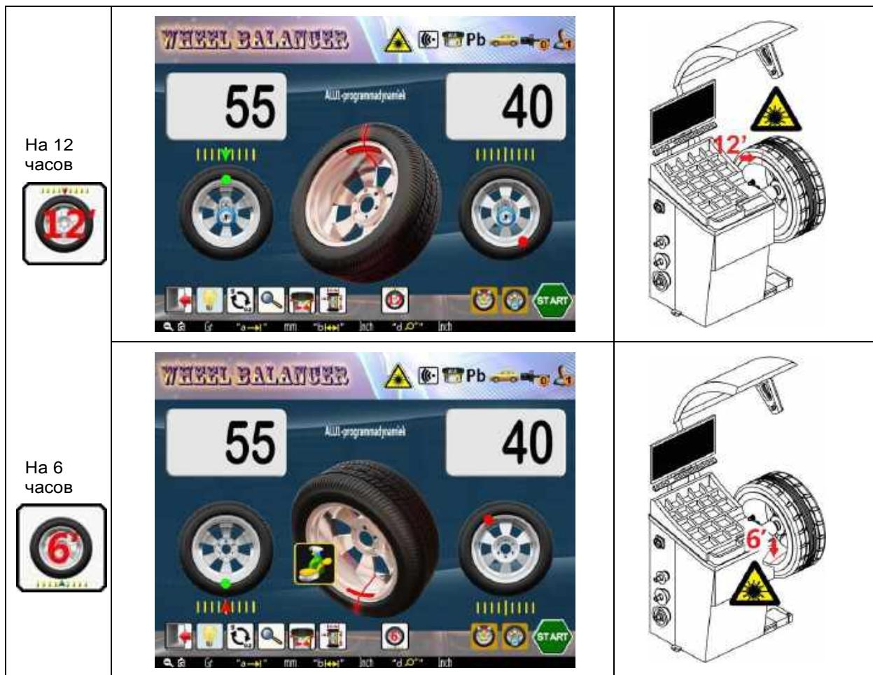
Рис.47 Измерение дисбаланса на внутренней стороне диска в режиме ALU1
