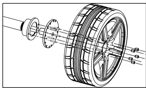
Рис. 16 Колесо без центрального отверстия
