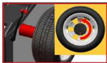
Рис.92 Калибровка нуля вала 2/2
