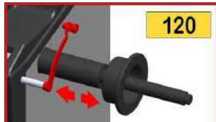
Рис. 8. Тест измерителя «а»
