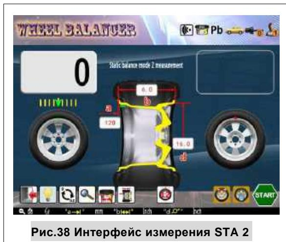
Рис.38 Интерфейс измерения STA 2
