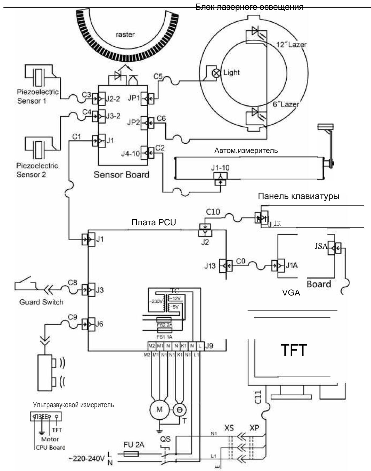
Рис.11О Станок HW9810 - электрическая принципиальная схема
