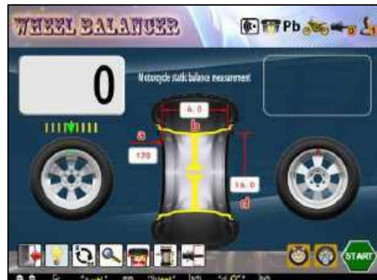
Рис.67 Измерение дисбаланса мото колеса
