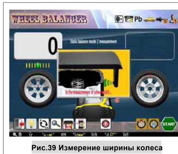
Рис.39 Измерение ширины колеса
