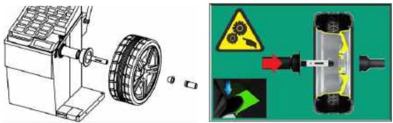
Установка колеса способом «конус -с наружки». Монтаж и демонтаж колес
