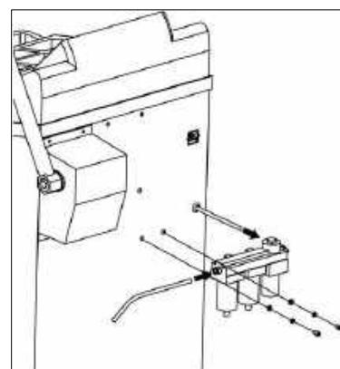
Рис.11 Подключение электропитания Рис.12 Подключение сжатого воздуха
