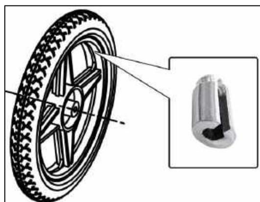
Рис.68 Грузик для мото колеса при статической балансировке
