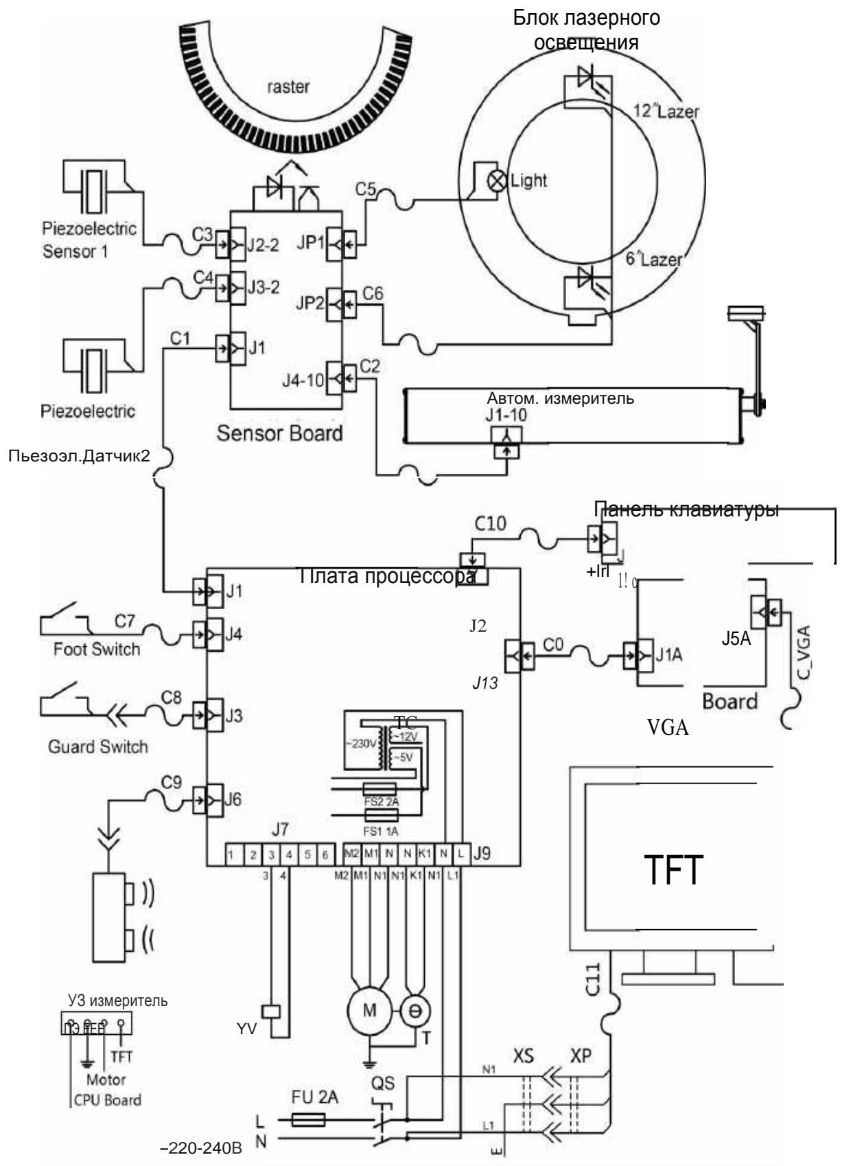
Рис.111 Станок HW9820 - электрическая принципиальная схема
