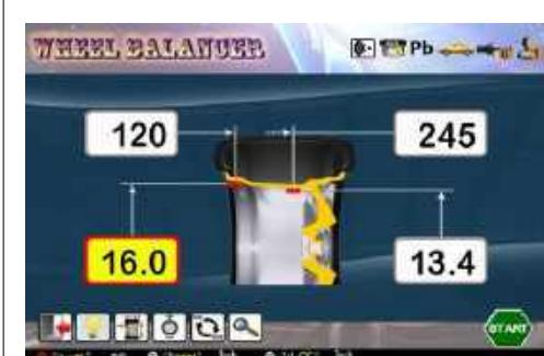
Рис.25 ввод или изменение параметров в режиме EALU1
