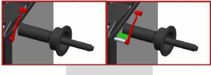
Рис.97 Калибровка измерителя расстояния «а».
