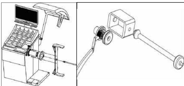
**Рис.64 Установка аксессуара для колес мотоциклов**
