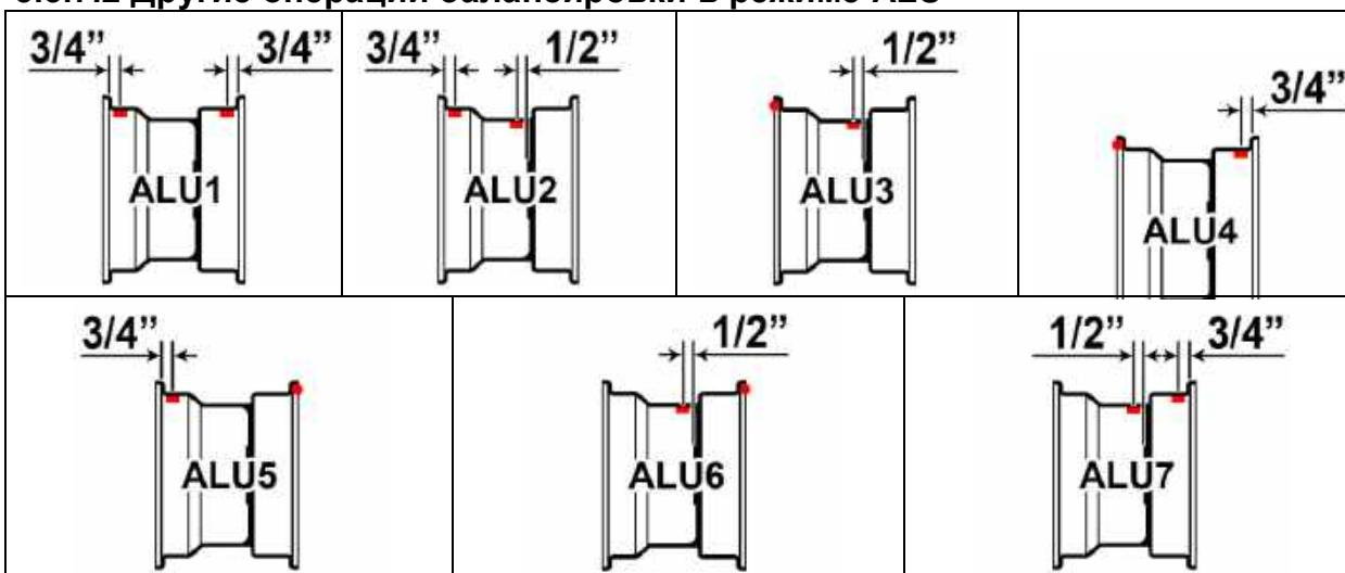
Рис.48 ALU1-7 положения для клейких и набивных грузиков
