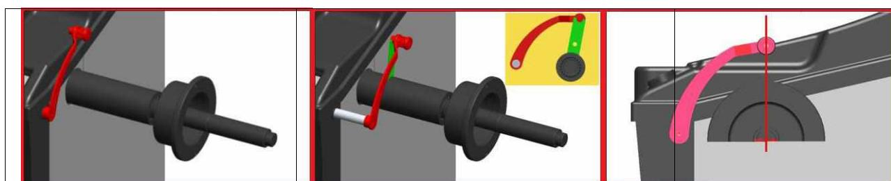
Рис.99 Калибровка измерителя диаметра «d»
