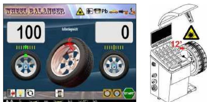
Рис.95 Программа калибровки грузиком 3
