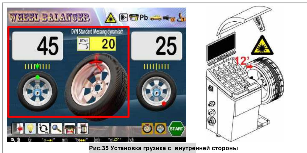
После установки грузика с внутренней стороны, нажмите , система автоматически повернет колесо к точке коррекции дисбаланса с внешней стороны и заблокирует колесо. Выполните операцию, показанную на рис. 36, чтобы завершить корректировку дисбаланса по внешней плоскости диска. На этом операция динамической балансировки завершена.
