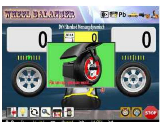
Рис.33 Измерение дисбаланса
