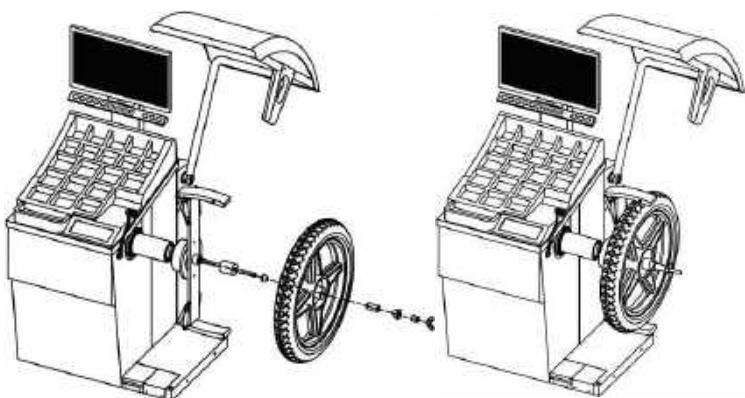
**Рис.66 Крепление колеса мотоцикла**
