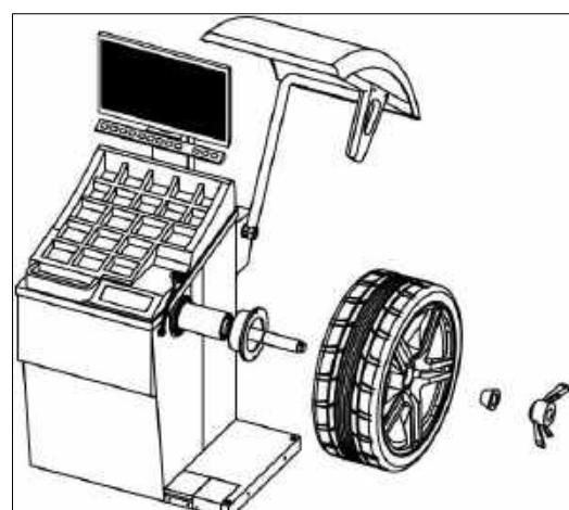
Установка колеса «обратным» способом (конус – снаружи)
