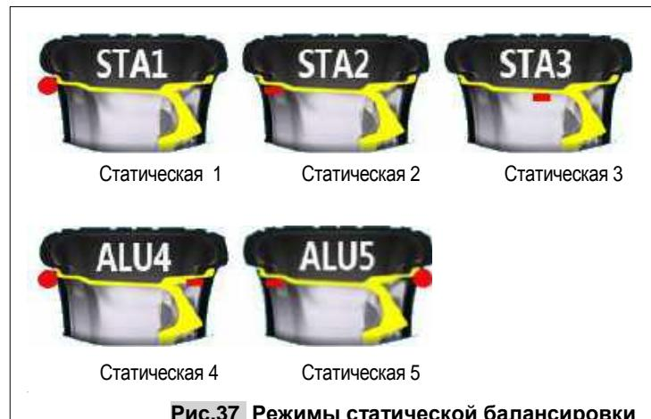
Рис.37 Режимы статической балансировки
