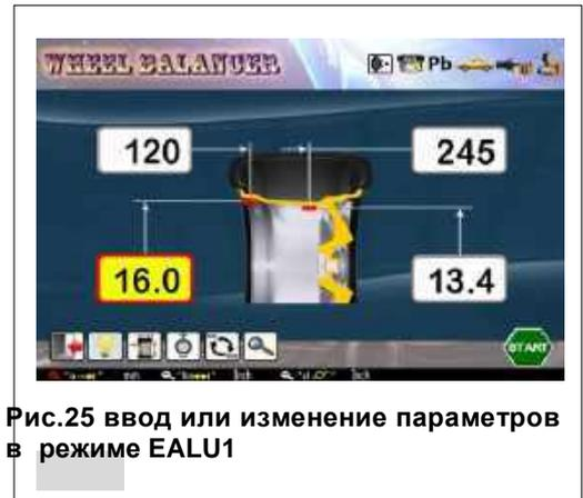
Рис.25 ввод или изменение параметров в режиме EALU1
