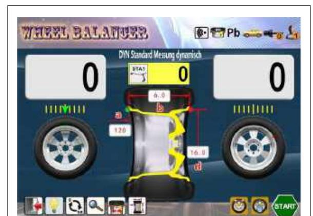
Рис. 31 Стандартная динамическая балансировка
