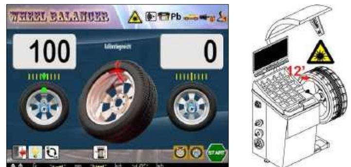
Рис.95 Программа калибровки грузиком 3
