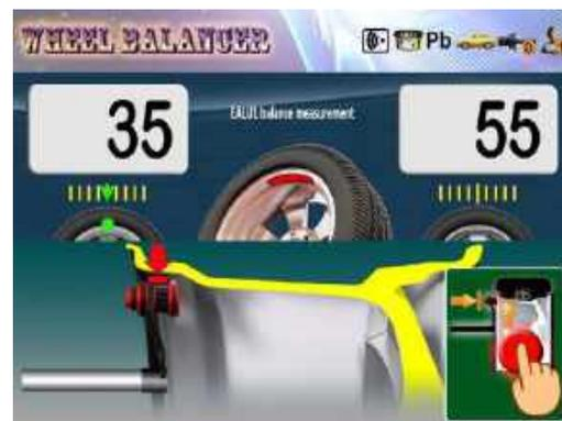
Рис.55 Операция приклеивания грузика на внутренней стороне в режиме EALU2
