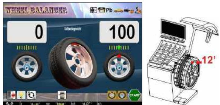
Рис.94 Программа калибровки грузиком 2
