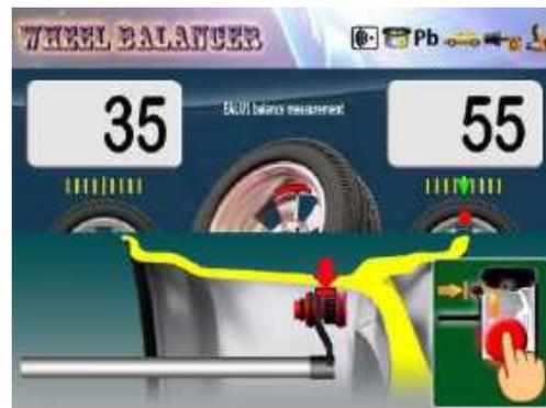
Рис.54 Операция приклеивания грузика на внешней стороне в режиме EALU1
