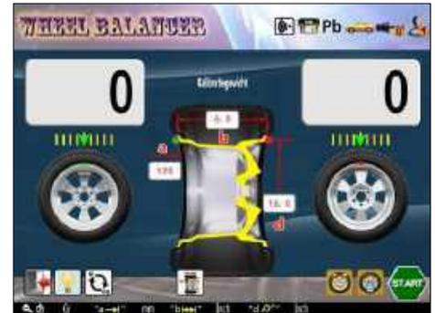
Рис.93 Программа калибровки грузиком 2
