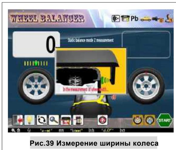
**Рис.39 Измерение ширины колеса**
