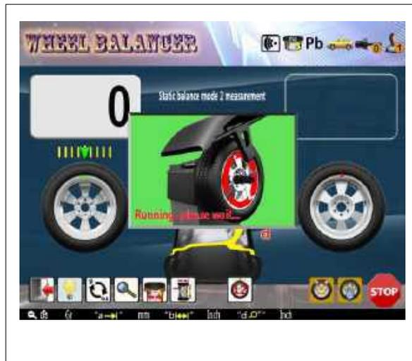
Рис.40 измерение статического баланса
