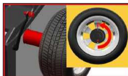
Рис.92 Калибровка нуля вала 2/2
