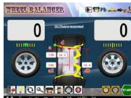
Рис. 51. Режим балансировки EALU2
