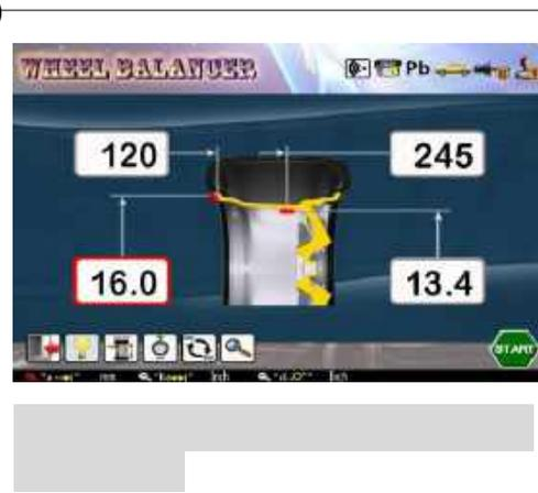
Рис.24 ввод или изменение параметров в режиме EALU2
