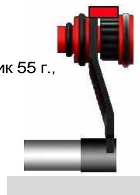
Рис.53 Концевой зажим измерителя
