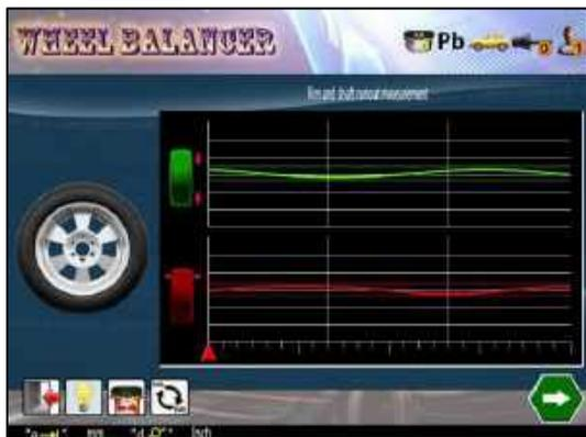
Рис.70 Измерение биения (PP)
