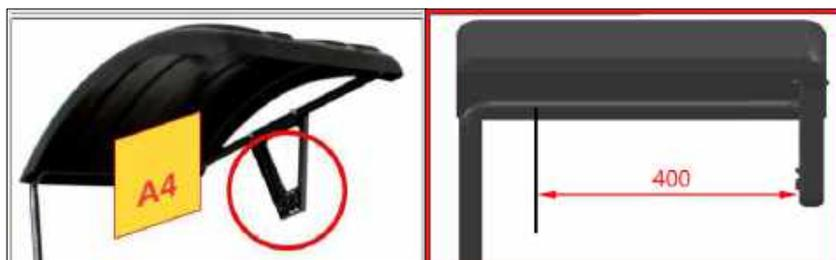
Рис.101 Калибровка Измерителя ширины «b»
