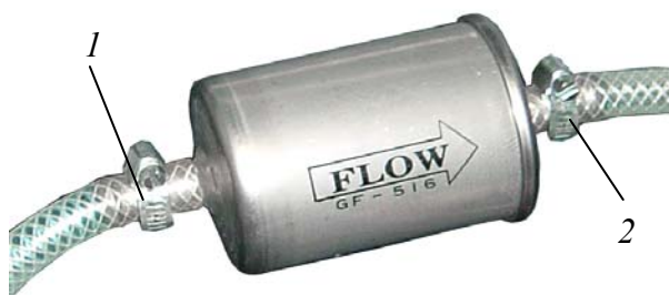
Рис. 11. Фильтр тестирующей жидкости: 1,2 – крепежные хомуты.
